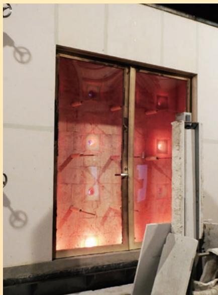
特定防火設備加熱試験炉
